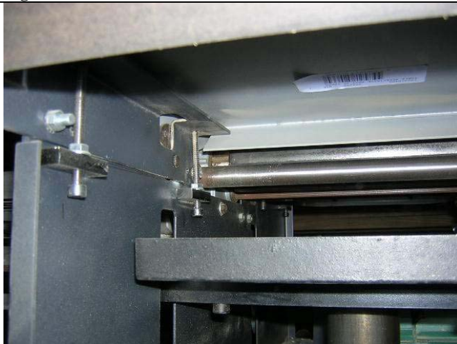
Fig.8 - Butées table entrée à Gauche
