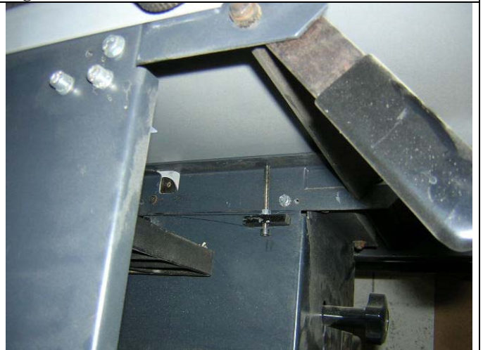
Fig.9 - Butées table entrée à Droite
