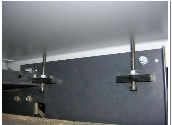
Fig.7 - Butées table sortie à Gauche
