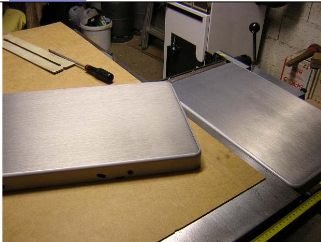
Fig.6 - Table entrée démontée
